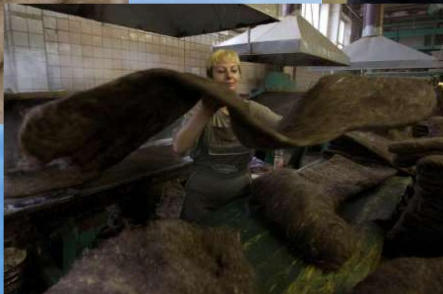
Затем эту заготовку натягивают на колодку и отбивают со всех сторон деревянной колотушкой, пока изделие не примет обычный для валенка размер.
